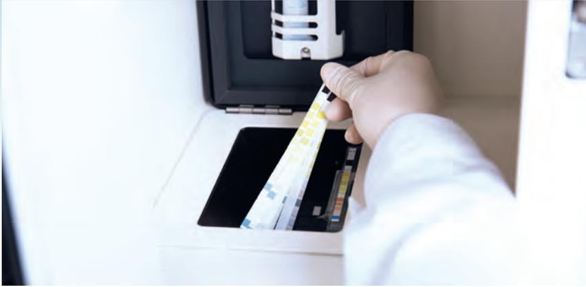
Das fortschrittliche CIS-Farberkennungssystem führt zu einer hohen Genauigkeit und Effizienz, die 5-Wellenlängen-Kolorimetrie garantiert präzise und sichere Ergebnisse.
