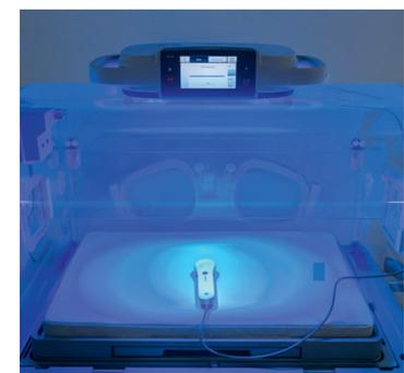
Bestrahlungsstärke-Sonde zur genauen Messung/Anzeige der Strahlungsintensität
