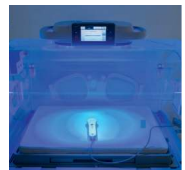
Bestrahlungsstärke-Sonde zur genauen Messung/Anzeige der Strahlungsintensität
