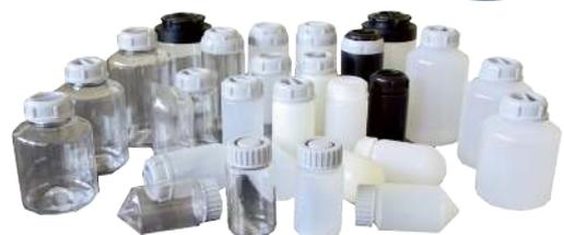
Alle Produkte sind auf Dichtheit und die maximale G-Zahl getestet. Im Allgemeinen halten die wiederverwendbaren Zentrifugenröhrchen und -flaschen etwa 40 Zentrifugationsläufe aus.
