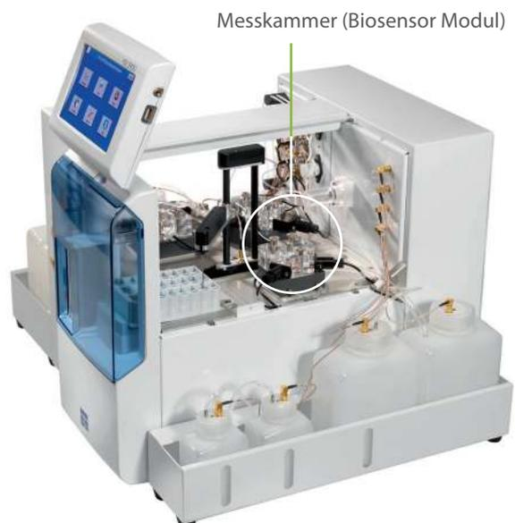
Messkammer (Biosensor Modul)
