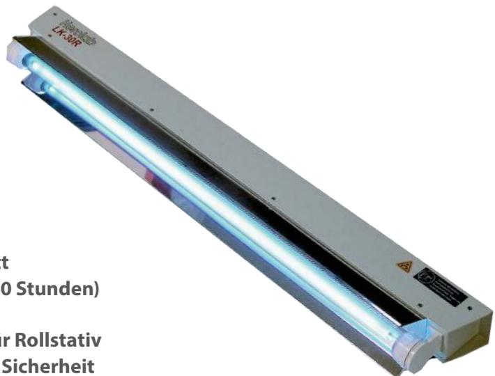
Die verwendete Wellenlänge von 254 nm ist sehr gut geeignet um Bakterien, Viren und Pilze bzw. Sporen abzutöten (das energiereiche UV-C Licht zerstört die DNA- bzw. RNA-Struktur der Mikroorganismen).
