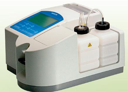
Wasserpotentialmessung im Labor mit dem **VAPRO® 5600**
